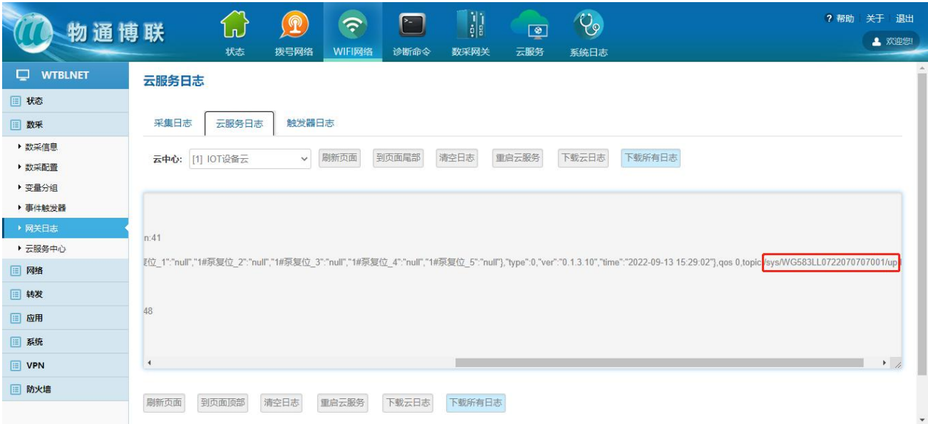
(4) 下行主题定义：在云服务中心——对应的中心类型中点击修改——MQTT 主题中进行对下行主题自定义，不定义默认 Topic 为：/ gatewaySn/down
